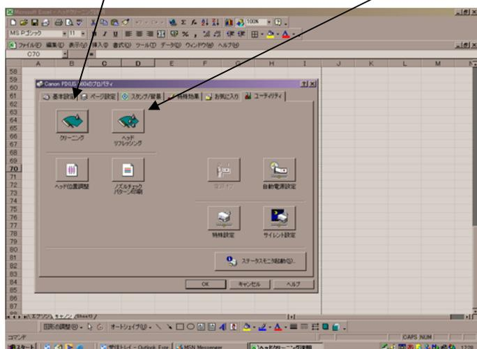
①まずヘッドクリーニングを行い、インクの出力を確認する
